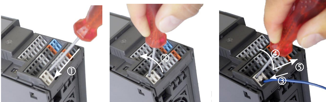
Obr. 15 Postup při upevnění vodiče v řídicí svorkovnici
